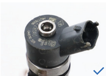
Elektrický konektor bez poškození
