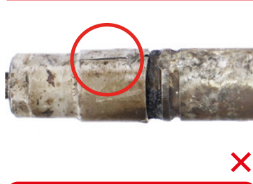
Tělo vstřiku nemá původní (originální) tvar z důvodu zbrusušení nebo jiného vnější zásahu
