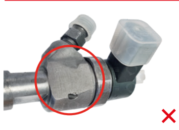
Tělo vstřiku nemá původní (originální) tvar z důvodu zbrusušení nebo jiného vnější zásahu
