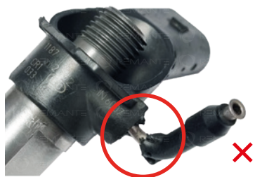
Poškozený nebo uvolněný přepad
