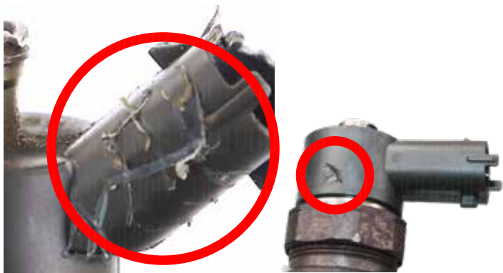
Poškozený konektor – škrábance
